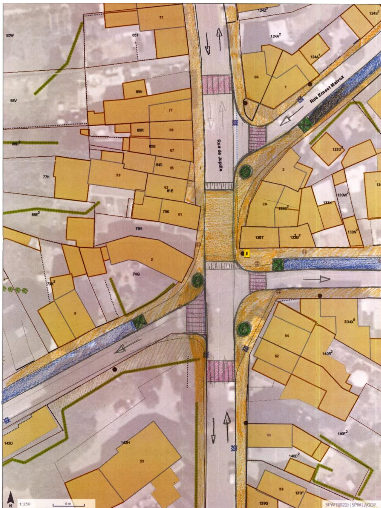
Figure 60 : esquisse sécurisation du carrefour - source : Agora 2023
